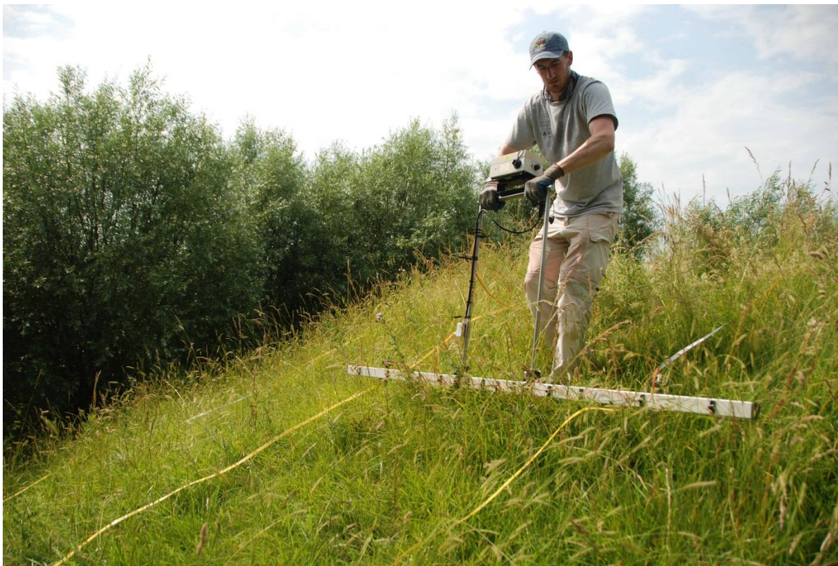
Borssele-Monsterweg. Geofysisch onderzoek in de vorm van weerstandsmetingen op de motte Berg van Troje. Foto Stichting B400, Borssele.
