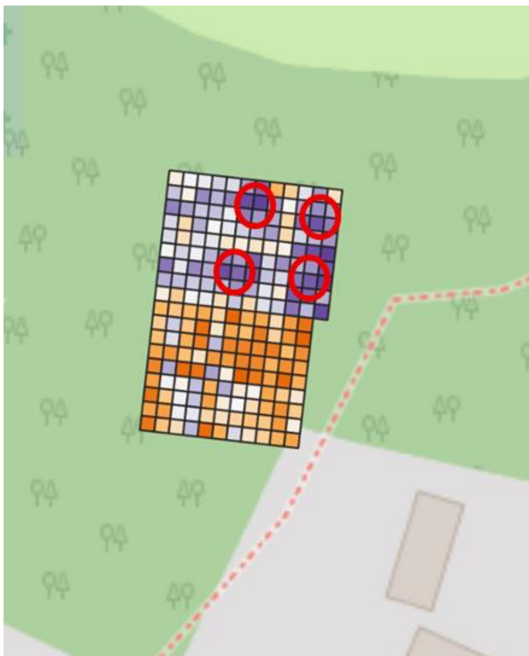
Figuur 33 Zone 1 voorterrein. Weerstandsmetingen met interpretatie in rood. (uitsnede figuur 32)
