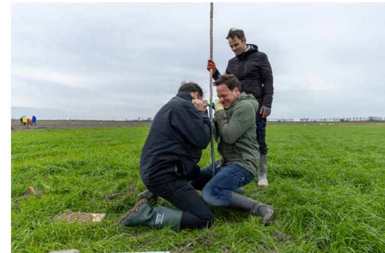
↑ Grondboring met een guts | foto Wesley Versteeg.
